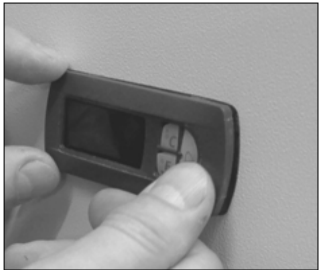
Imagen 12: Colocación de la tapa
