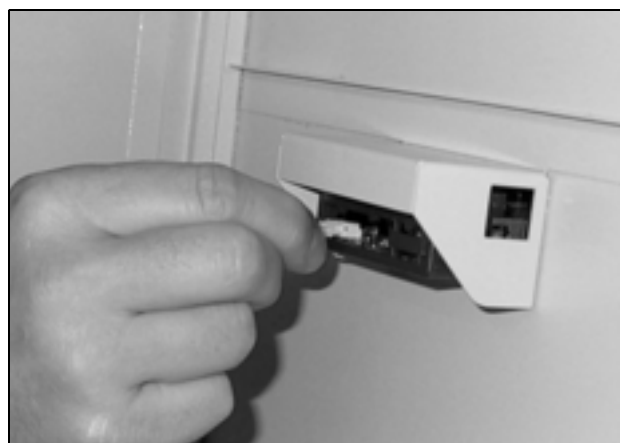
Imagen 29: Desconectar el display
