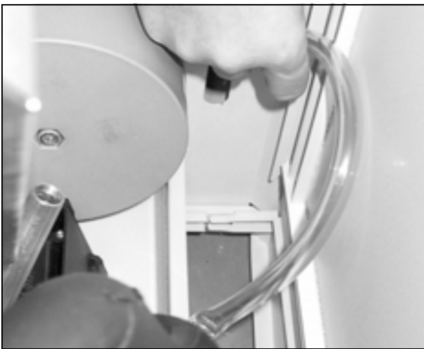
Imagen 9: Extracción del aparato del tubo de salida del agua de condensación
