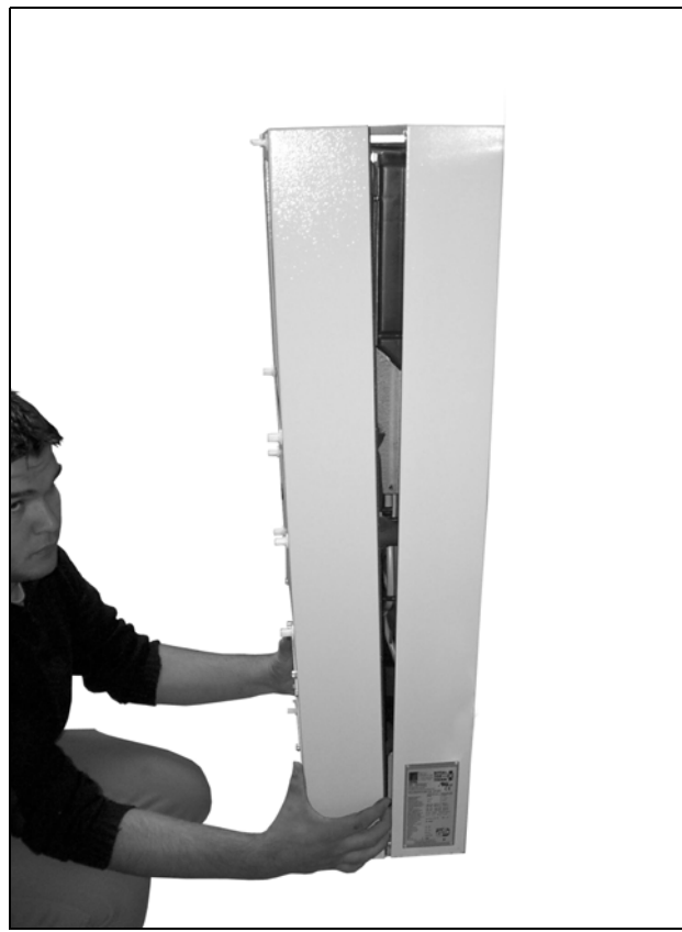
Imagen 48: Retirar la cubierta (2)
