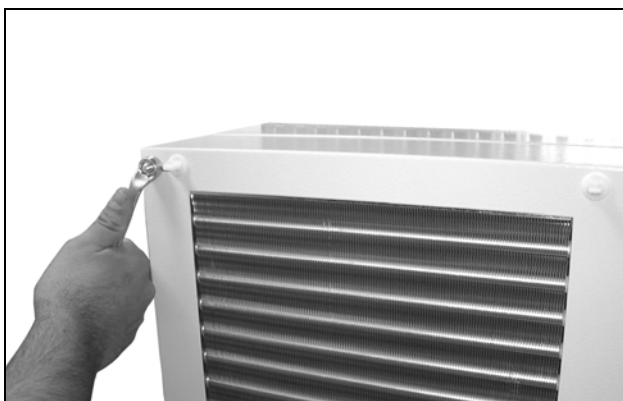
Imagen 44: Desmontar la cubierta (extraer las cuatro tuercas)
