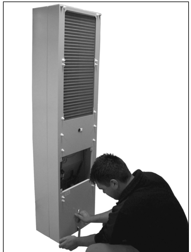
Imagen 70: Desenroscar las cuatro tuercas de la cubierta
