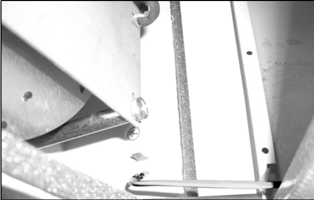
Imagen 49: Desconectar el cable de puesta a tierra entre la cubierta y el chasis (1)
