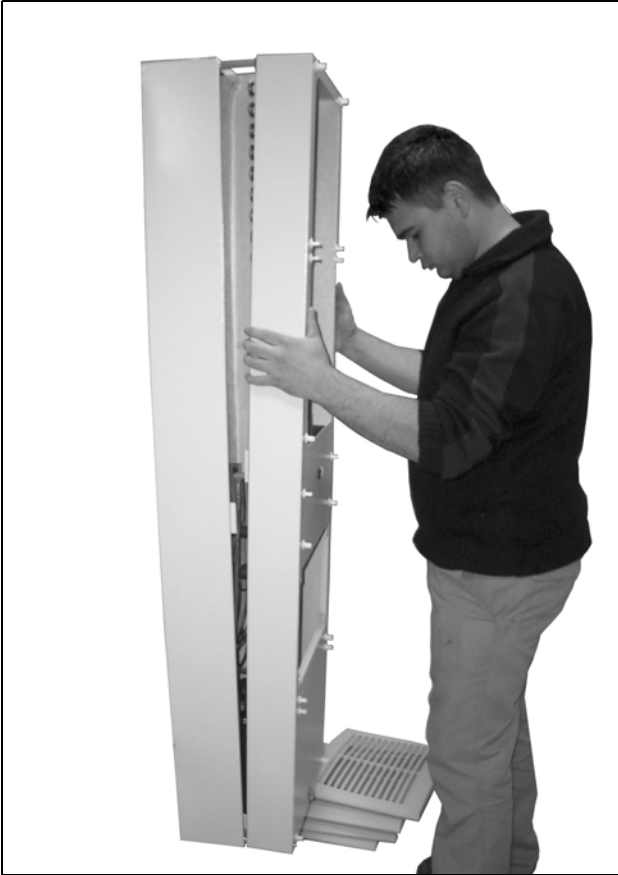
Imagen 71: Retirar la cubierta
