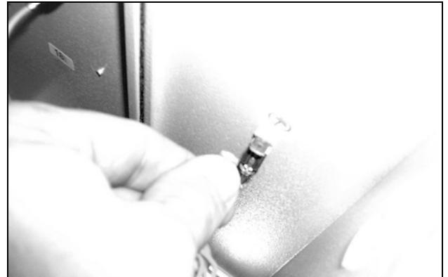
Imagen 69: Desconectar el cable de puesta a tierra del ventilador (2)
