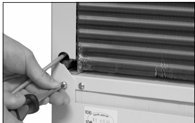
Imagen 26: Extraer los tornillos de fijación de la cubierta (extraer cuatro tornillos)
