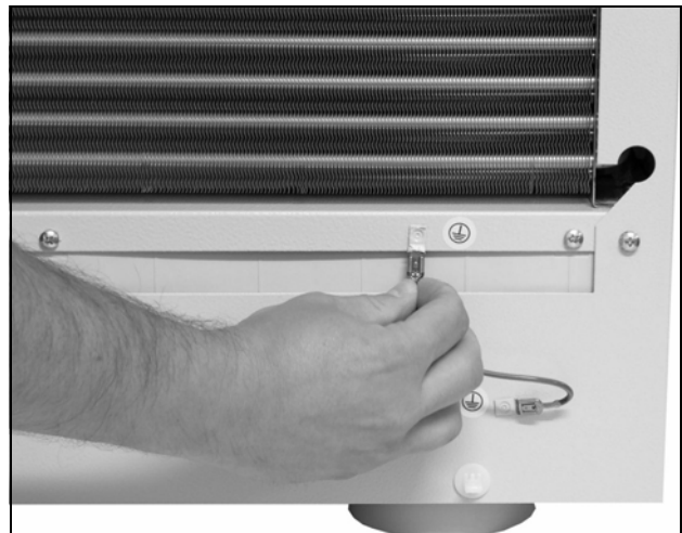
Imagen 25: Desconectar el cable de puesta a tierra
