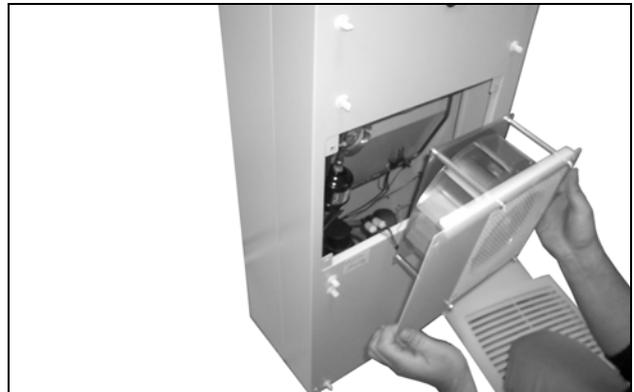
Fig. 64: Remove the external circuit fan
