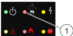
Fig. 21: LED “Instalación de extinción activada”
