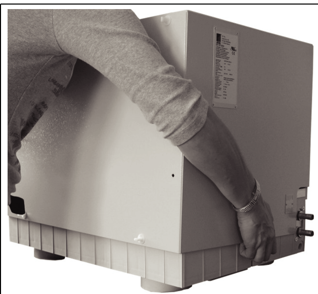
Imagen 28: Retirar la cubierta
