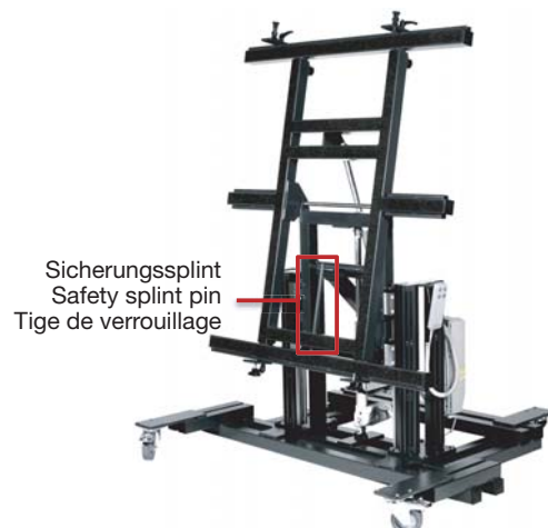
3.3 Montagetisch 300 ENH Position des Sicherungssplint Assembly frame 300 ENH Position of the safety split pin Établi de montage 300 ENH position de la tige de verrouillage
