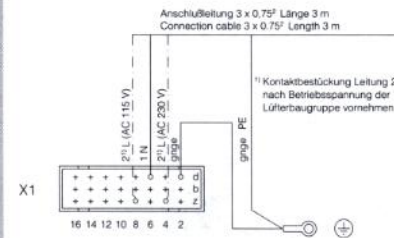
Abb. 4.6 Anschlußbelegung Führungsrahmen SK 3357 100, SK 3358 100 für Einschublüfter Vario
