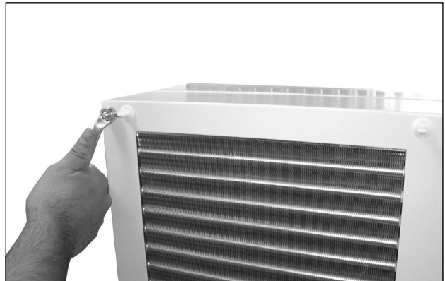
Imagen 51: Desmontar la cubierta (extraer cuatro tornillos)
