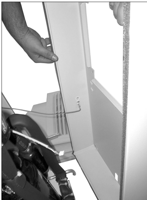
Imagen 79: Desconectar el cable de puesta a tierra (1)
