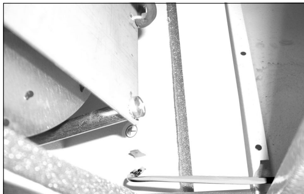
Imagen 56: Desconectar el cable de puesta a tierra entre la cubierta y el chasis (1)
