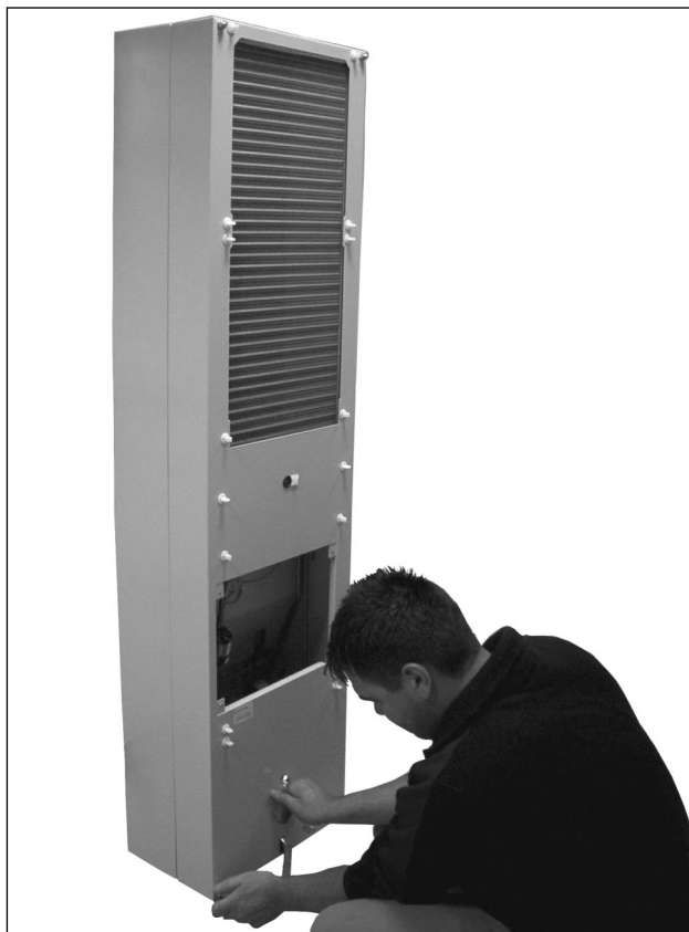
Imagen 77: Extraer los cuatro tornillos de la cubierta
